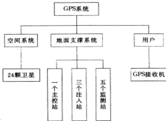
图1.1 GPS系统结构
